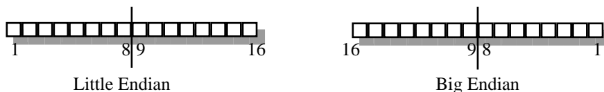
Abbildung 32: Darstellung eines 16-Bit Wortes bei Big- und Little- Endian Architekturen
